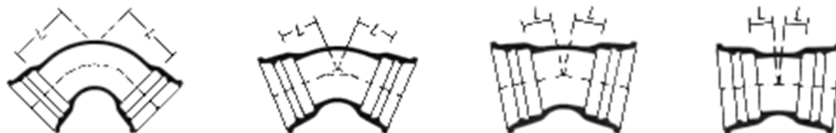
Figura 03 – Curve disponibili tubazioni in ghisa sferoidale
